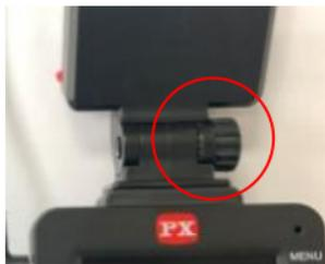
※若需要調整角度，請先「向後」鬆開轉軸旋鈕(如左圖)，調整最佳拍攝角度位置後，再將轉軸旋鈕「向前」旋轉固定即可。
