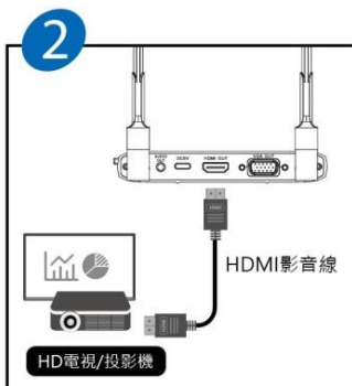
2.接收器連接顯示器設備: 將HDMI影音線,一端接要顯示畫面的顯示器設備輸入端,另一端連接接收器的HDMI輸出位置 ※備註:HDMI線材自備
